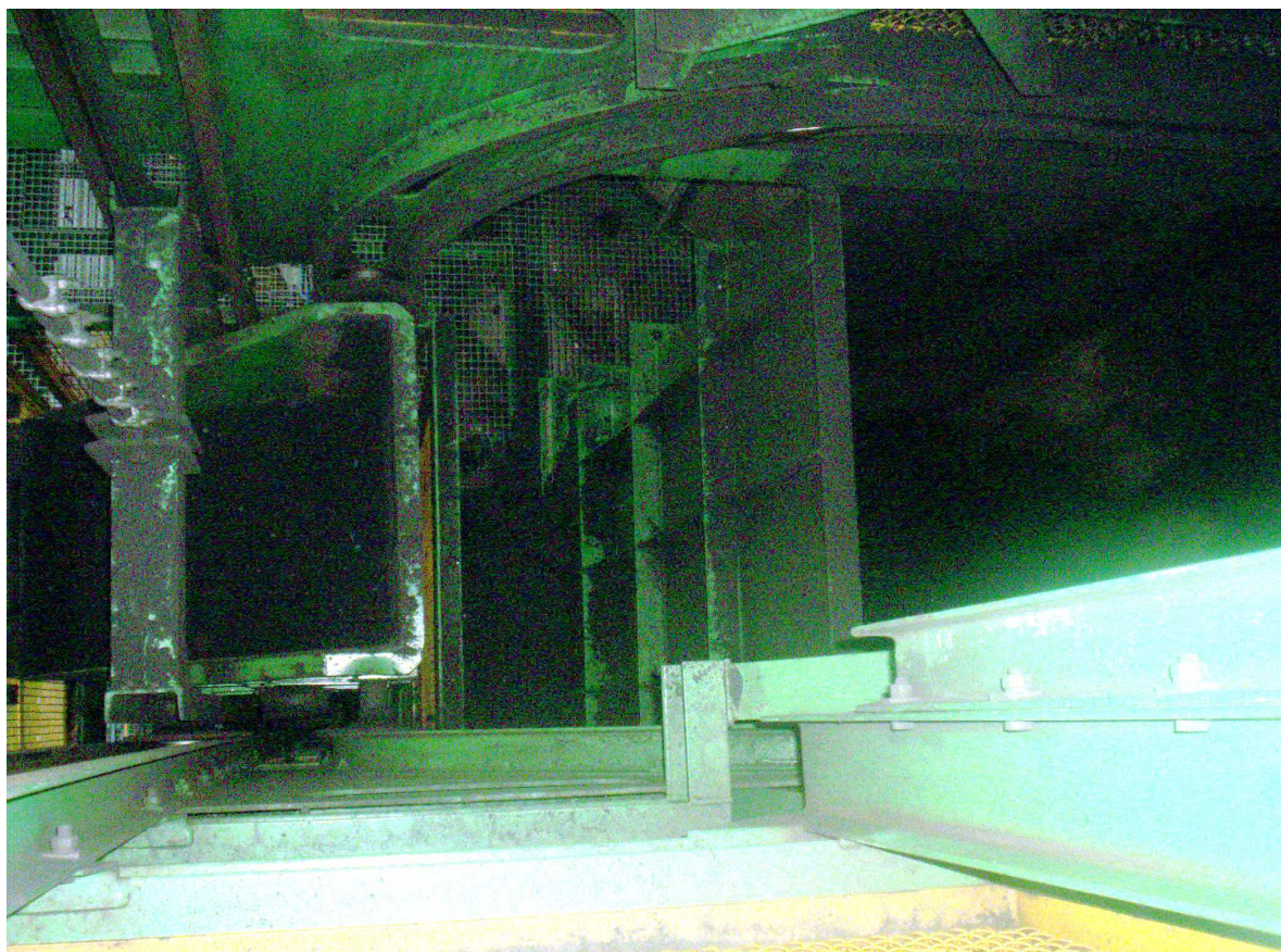
Rysunek 14: Szyb elewatora – widok z góry (po lewej skip, po prawej górny zbiornik) (fotografia autora wykonana za zgodą przedstawiciela zakładu)
