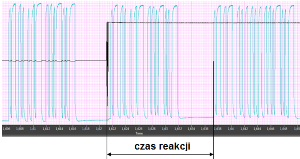
RYSUNEK 5.2. Sposób wyznaczania czasu reakcji dla narastania na podstawie danych pomiarowych w postaci cyfrowej (zbliżenie)
