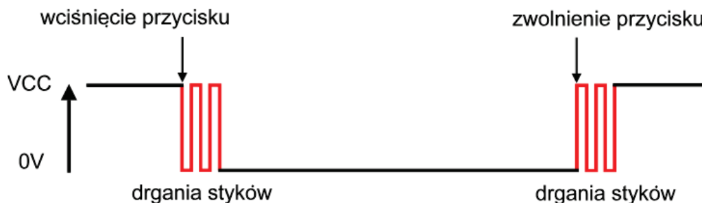
RYSUNEK 3.2. Drgania na stykach przycisku.
